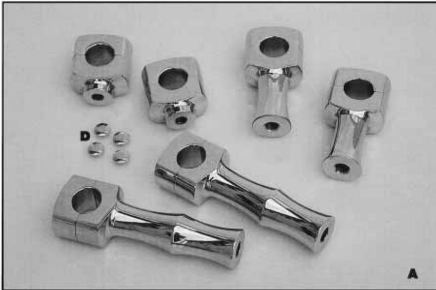
Die oberen Befestigungsschrauben sind bei allen AME-Lenkerhaltern serienmäßig aus Edelstahl !
