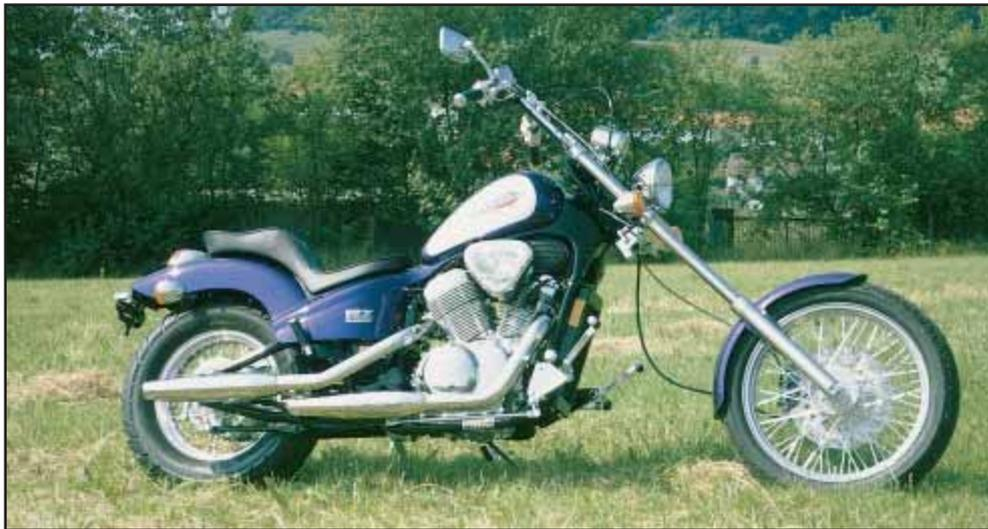
der Chopper-Version serienmäßig ausgestattet mit langer Gabel, gereckten Gabelbrückensätzen 14 °, Stahlflexbremsleitung und Tachowelle, TÜV- abgenommen mit Fahrzeugbrief.
